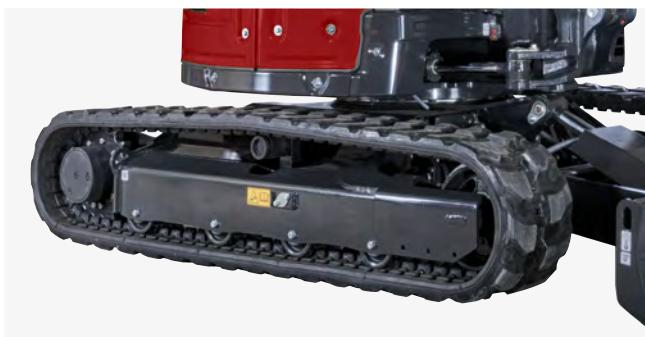
La structure solide du châssis en X offre une excellente résistance à la flexion par torsion. Le châssis est conçu pour une durabilité maximale.
